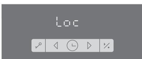
**3** Po určitej dobe sa dvierka rúry automaticky zablokujú kvôli vašej bezpečnosti. Na displeji sa objaví "Loc" (po dobu 3 sekúnd).
