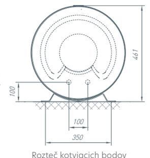
Rozteč kotvacích bodov
